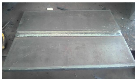
图 1 平焊焊缝成形
