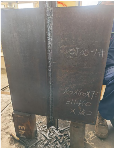
图 3 CTOD 试板焊接
